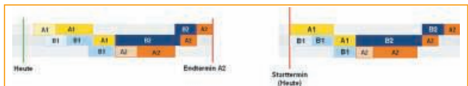
Gantt-Diagramme ermöglichen die Optimierung der Auftragsreihenfolge unter verschiedenen Gesichtspunkten: Die Rückwärtsterminierung ( links ) sorgt beispielsweise für kürzere Auftragsdurchlaufzeiten; die Vorwärtsterminierung ( rechts ) erlaubt Aussagen über die Fertigstellungstermine und Puffer.
