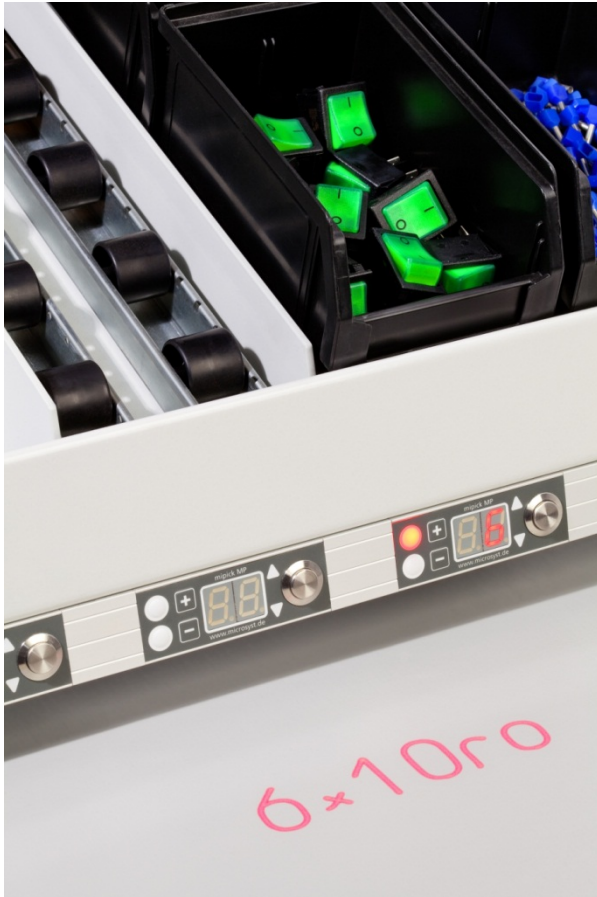
Karl_Laserarbeitsplatz_Detail_Picktolight-004.jpg: Blinkende Leuchten an den FIFO-Regalfächern deuten dem Werker an, welches Material er zu verwenden hat und verhindern dadurch Fehleinbauten durch Verwechslung.
